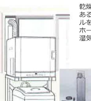
乾燥機の近くに窓がある場合は、窓パネルを利用して排湿ホースにより、湿気を排出。
